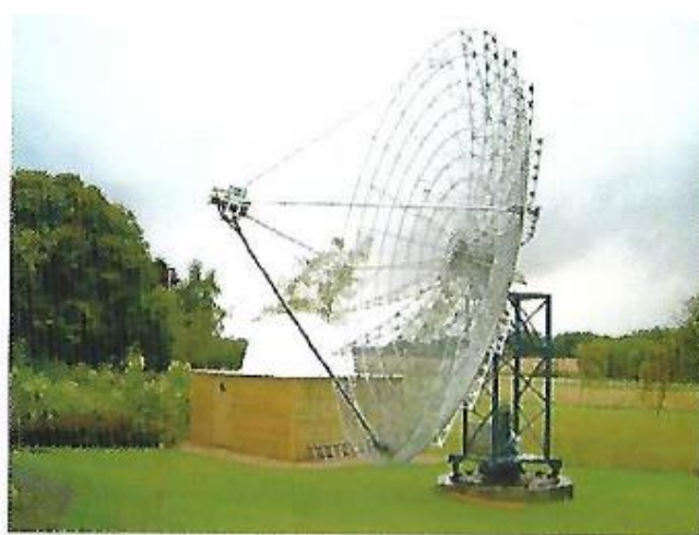
Carsten Grøns 8m hjemmebyggede parabol, som fik etableret kontakt til AAU-satellitten. Foto: Carsten Grøn.
