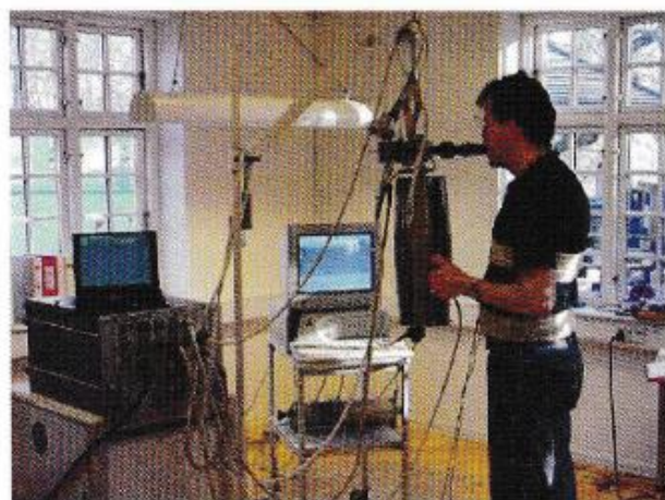
Genåndingsapparatet i test hos Innovision. På Rumstationen vil det være pakket sammen med andet udstyr. (foto: Innovision A/S ©)
