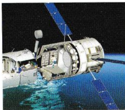
ATV'en koblet til Rumstationen. Forsyninger hentes til Rumstationen og affald deponeres for senere at brænde op i atmosfæren. (illustration: ESA ©)
