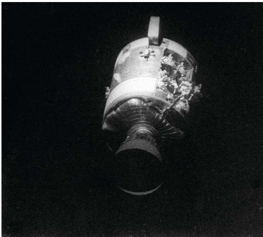
Det svært beskadigede servicemodul fotograferet få timer før landingen, hvor servicemodulet blev frigjort. Det var første gang, astronauterne direkte kunne se skaderne. Billede: NASA
