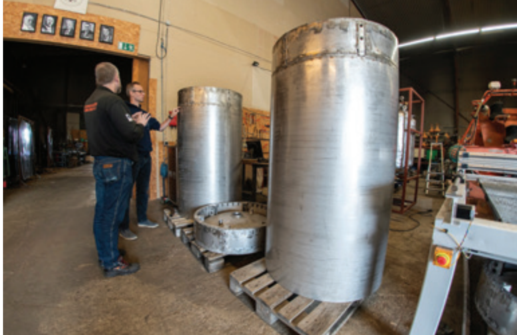
Brændstoftankene til Spica I tager form. Foto: CS
