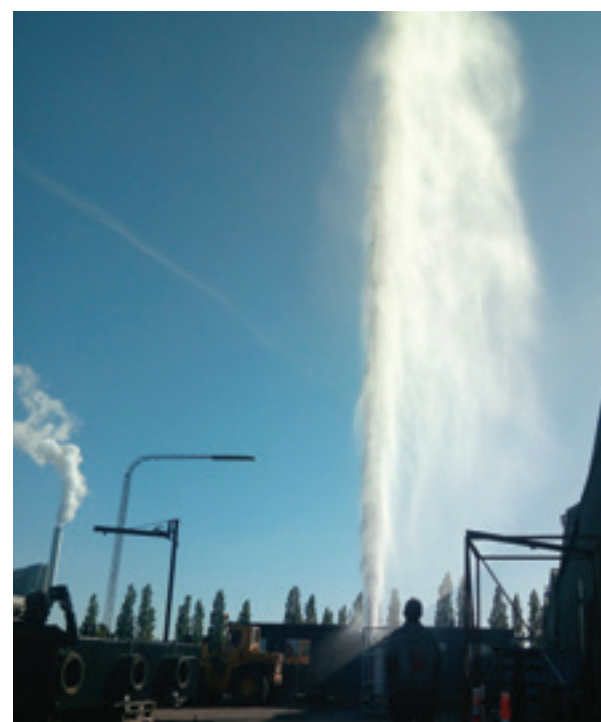
BPM-100 raketmotoren sluger 50 liter væske per sekund. Sådan ser det ud når man sender det opad. Foto: CS
