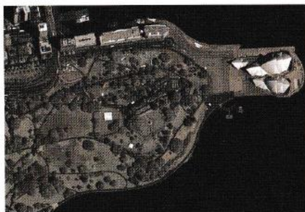
Figur 3. QuickBird data der viser operahuset i Sydney. Den mindste billedenhed, en pixel, er på ca. 60 cm (© DigitalGlobe).
