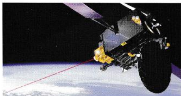
Figur 3: Artemis er en af de nye teknologier for kommunikationssatellitter. ESA har sat i værk. Målet er udover at fungere som retransmission satellit til satellit ved hjælp af laser.
