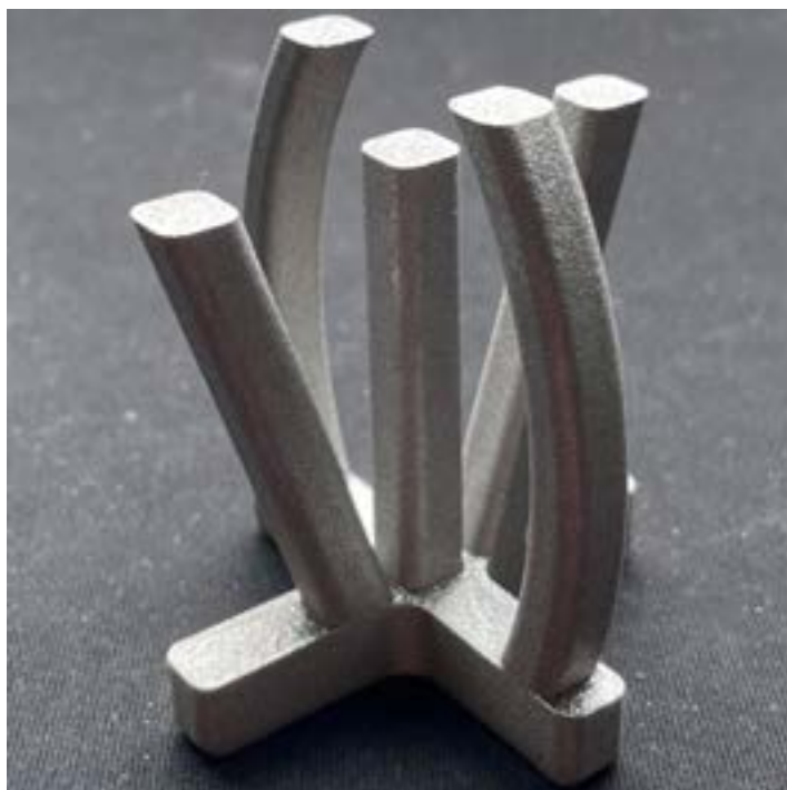
To eksempler på tidlige test-emner i metal, printet på en test-printer, ikke den, der skal på rumstationen. Foto: DTU Space
