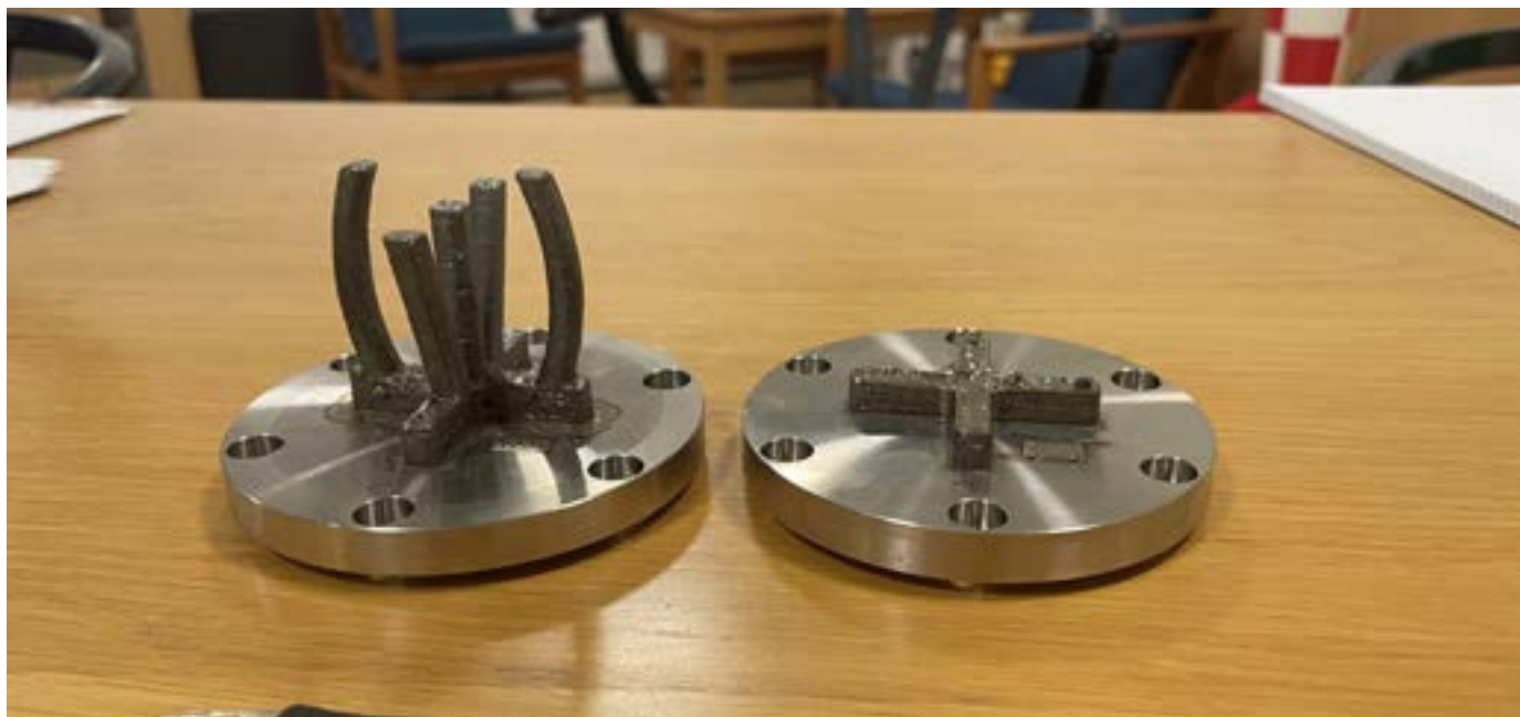
Her ses en af de originale test-emner, der er 3D-printet her på Jorden på maskinen, som skal ud til rumstationen. Foto: DTU Space
