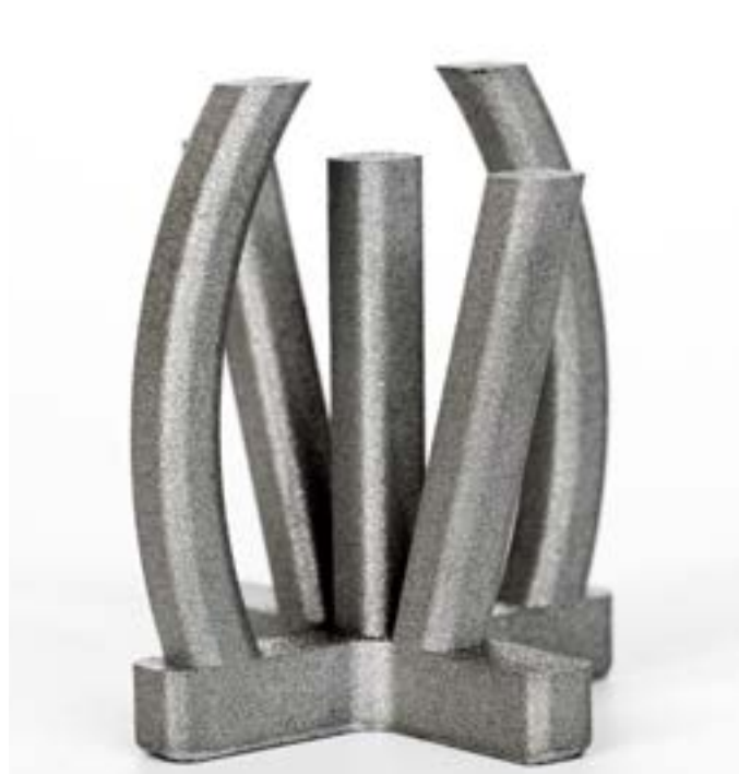
To eksempler på tidlige test-emner i metal, printet på en test-printer, ikke den, der skal på rumstationen. Foto: DTU Space
